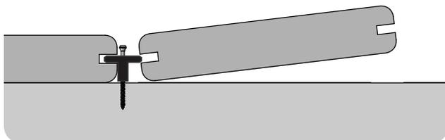
À l'aide de l'embout du tournevis étoile T-15 inclus dans l'ensemble, enfoncez la vis jusqu'à ce qu'elle soit à 1/8 po (3 mm) au-dessus du haut de l'attache. Ne pas serrer complètement.
