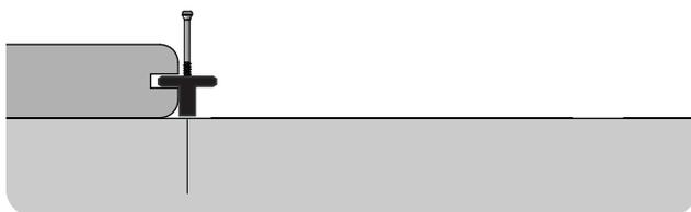
Insérez l'attache dissimulée AEGIS CLIP dans le côté rainuré et ouvert de la planche. Alignez le clip au centre de la poutre; l'attache dissimulera la poutre lorsqu'elle est correctement installée.
