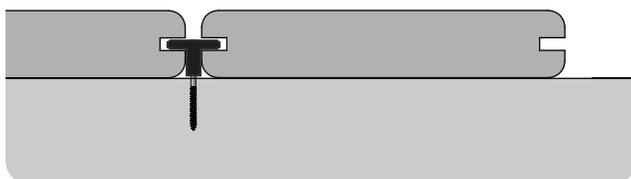
Vérifiez que le clip est complètement enclenché dans la rainure et enfoncez la vis dans le clip. Veillez à ne pas trop serrer la vis pour éviter de courber le clip. Continuez à installer les planches sur le côté extérieur du plancher.
