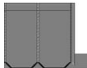
Détail de vis placées à 12 po c/c Figure 5c
